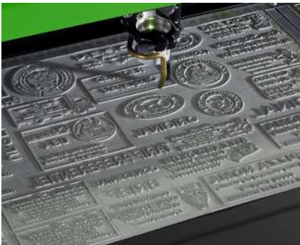
Grabado y corte por láser de sellos de caucho personalizados
